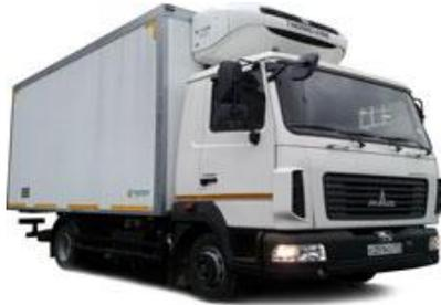
Один из наших валидированных грузовиков вместимостью до 12 паллет, оборудованный климатической установкой Thermo King, 2 датчиками регистрации температуры и самописцем Touchprint, подтверждающим температуру перевозки непосредственно при выгрузке (водитель выдает распечатку)
