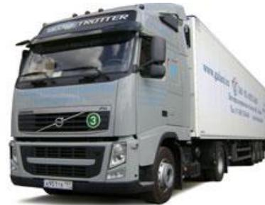
Один из наших валидированных грузовиков вместимостью до 66 паллет, оборудованный климатической установкой Carrier, 2 датчиками регистрации температуры и самописцем Touchprint, подтверждающим температуру перевозки непосредственно при выгрузке (водитель выдает распечатку)
